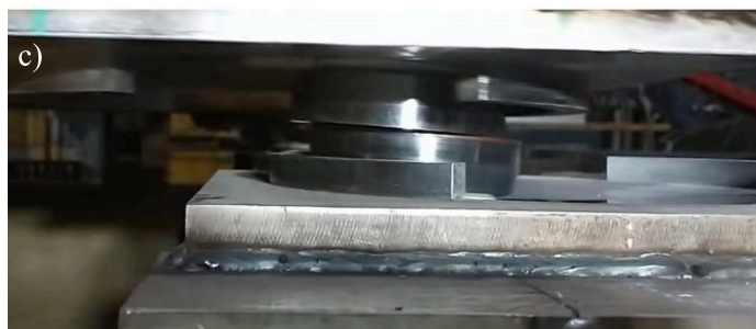
Figura 2: a) Componentes IR-DCFP; b) deslizador ensamblado y c) deslizador luego de impactar
