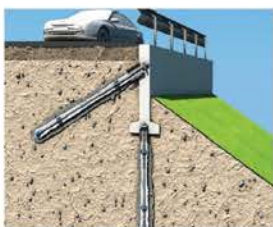
Cimentación y anclaje de estructuras
