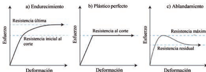
Figura 1: Relación esfuerzo-deformación para modelos elastoplásticos (Sørensen, 2012)
