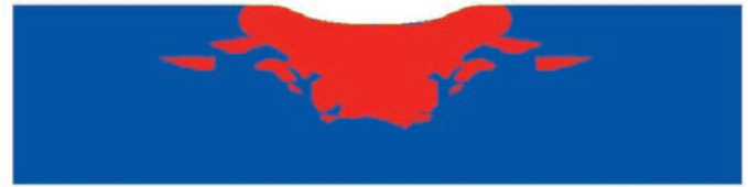
Figura 17: Zonas de compresión (azul) y tensión (rojo)
