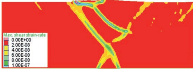
Figura 5: Zonas de máxima tasa de deformación cortante. Desplazamiento lateral de 34694 m
