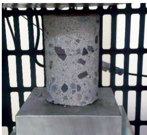
Figura 3: Ensayo de testigo de hormigón extraído del edificio en estudio
