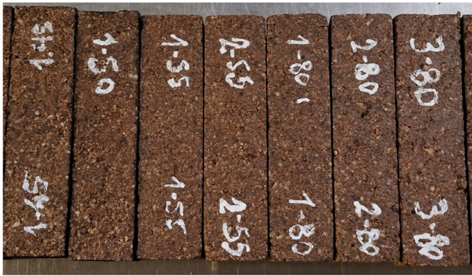
Figura 10: Muestras prismáticas de aglomerados de semillas de papayas.
