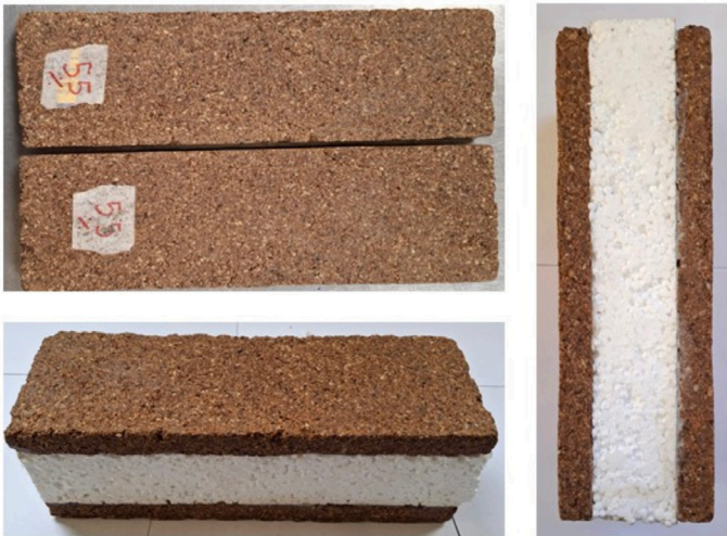
Figura 11: Prototipo de panel SIP con placas SP 55.
