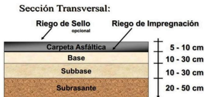
**Figura 2: Estructura de un pavimento flexible**
