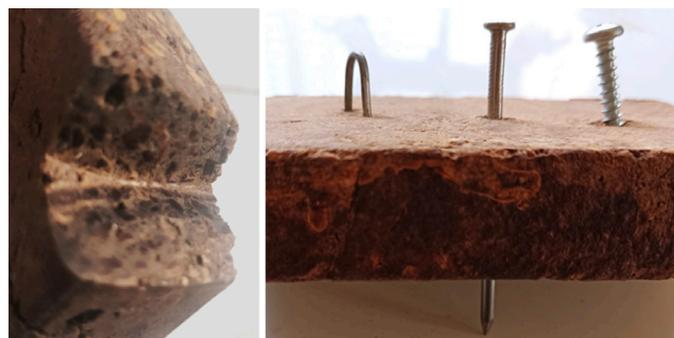
Figura 3: a) Corte con disco y b) clavado y atornillado en un parquet de orujo de oliva
