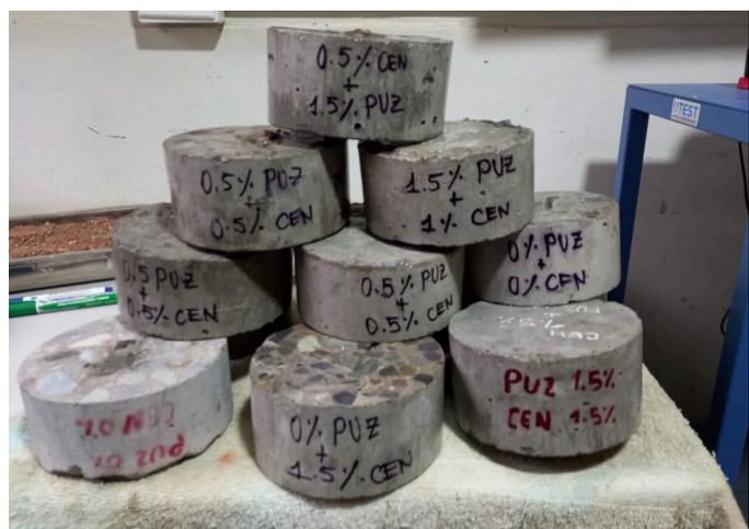
Figura 3: Probetas para ensayos de permeabilidad
