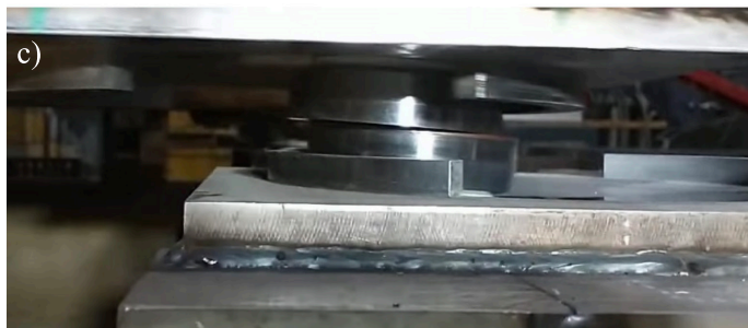
Figura 2: a) Componentes IR-DCFP; b) deslizador ensamblado y c) deslizador luego de impactar
