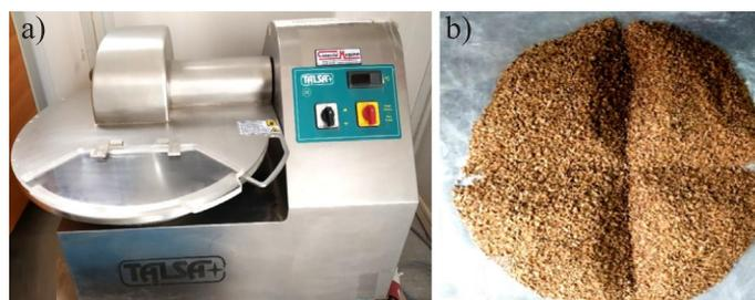
Figura 4: a) Máquina picadora y b) cáscara de nuez triturada
