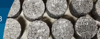
La dispersión se realizó incorporando el polvo de neumático en el asfalto colocado en la cuba inferior a temperatura para comenzar el mezclado. La incorporación se hizo en aproximadamente 5 min y el tiempo total en el equipo fue de 60 min. La velocidad a la cual se elaboraron las dispersiones estuvo entre 7000-7500 RPM y la temperatura entre 180 y 190°C. Posteriormente se procedió a la determinación de la penetración, punto de ablandamiento y viscosidad rotacional a 135°C y 170°C.
