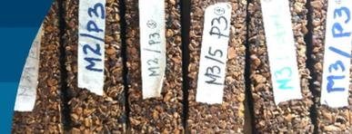
para su posterior caracterización y uso en la fabricación de los aglomerados. Las muestras se deshidrataron en un horno eléctrico a una temperatura de  $80^{\circ}\text{C} \pm 5^{\circ}\text{C}$  hasta alcanzar un peso constante. La Figura 3 muestra el aspecto del material original antes de su trituración.
