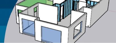
actividad, en este estudio se utilizó SketchUp (2017). Se modelan las distintas tipologías de vivienda, incluyendo la estructura de Metalcon para poder hacer una optimización de planchas de yeso cartón lo más acotado a la realidad, como se observa en la Figura 7. Para este primer paso, se necesitan los planos de arquitectura y detalle de Metalcon de cada tipología de casa, en su última versión.
