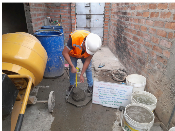
Figura 1: Medición de trabajabilidad
