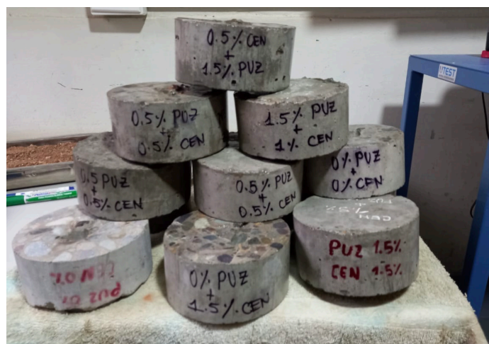
Figura 3: Probetas para ensayos de permeabilidad
