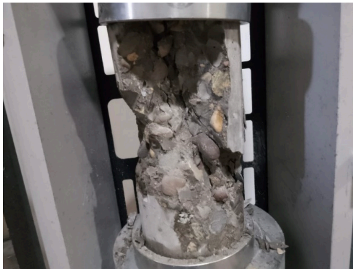
Figura 5: Rotura de probeta en un ensayo de compresión no confinado
