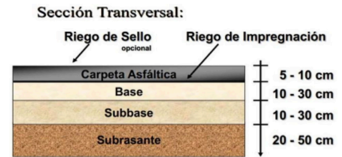
Figura 2: Estructura de un pavimento flexible
