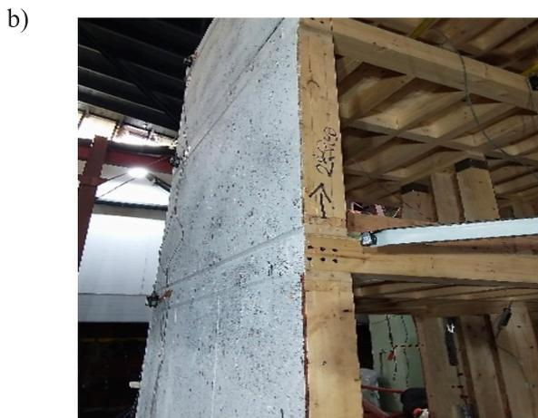
Figura 8: a) SDR y b) inspección visual del daño luego del ensayo
