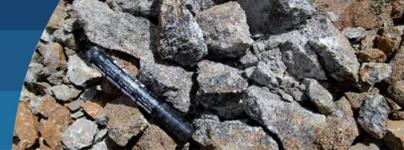
condiciones de apoyo muy diversas en las partículas, sino también la presencia de defectos naturales en la roca (fisuras, poros, relleno de grietas, alteración, entre otros). Por ello, Marsal para cada dimensión  $d_m$ , realizó 10 pruebas para dos estados de humedad, secados al aire y sumergidos en agua. En las Figuras 4a y 4b se presentan en escala logarítmica, los valores medios de  $\bar{P}_a$  en función del diámetro promedio para cada partícula ensayada.
